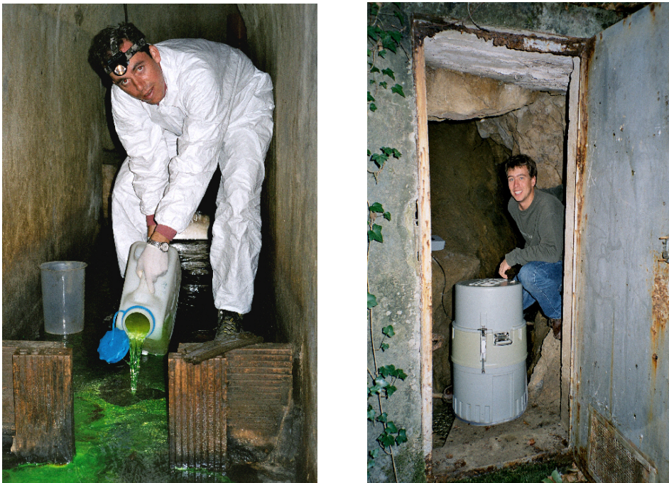
Abb. 4.25: Links: Eingabe des Fluoreszenzfarbstoffs direkt in die Schwinde, Rechts: Probenahme an der Moulinet-Quelle (Fotos: M. Pronk, N. Goldscheider)
